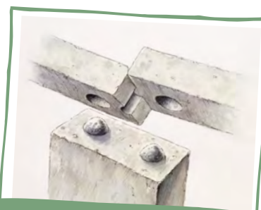
Ilustrace metody, která se používala ke spojení svislých kamenů a překladů mezi sebou.
