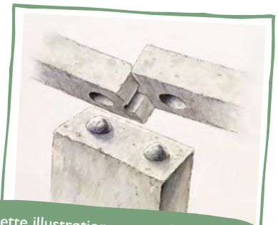
Cette illustration montre la méthode utilisée pour joindre les pierres verticales à l'aide des linteaux et pour joindre les linteaux entre eux.
